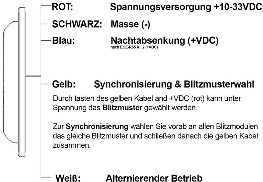
Zum **Alternieren** wählen Sie vorab an allen Blitzmodulen das gleiche Blitzmuster und schließen danach die gelben Kabel zusammen.
