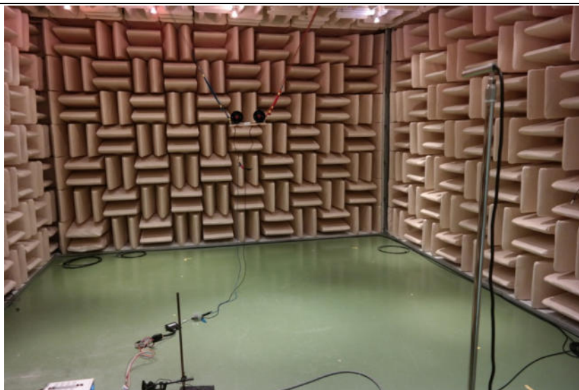
Bild 9: Messanordnung im reflexionsarmen Halbfreiefeldmessraum
