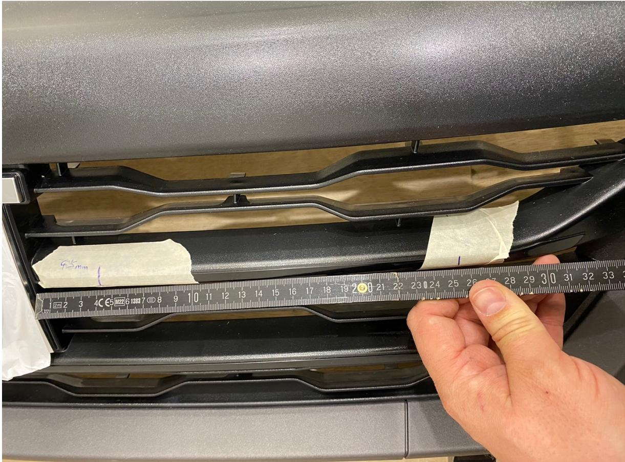
Der Schnitt muss entlang der Markierung ausgeführt werden.
