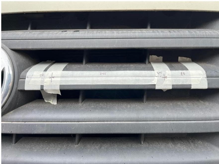
Von der 50mm Markierung werden 205mm für den Scheinwerfer und 10mm für die Halter. Also 215mm abgemessen Siehe Bild 2
