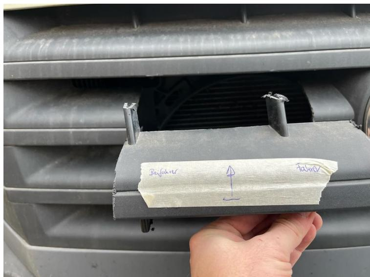
Dann müssen die Geschlossenen Lamellen geöffnet werden um Platz für Halter und Scheinwerfer zu machen. Rot Markierte Fläche.
