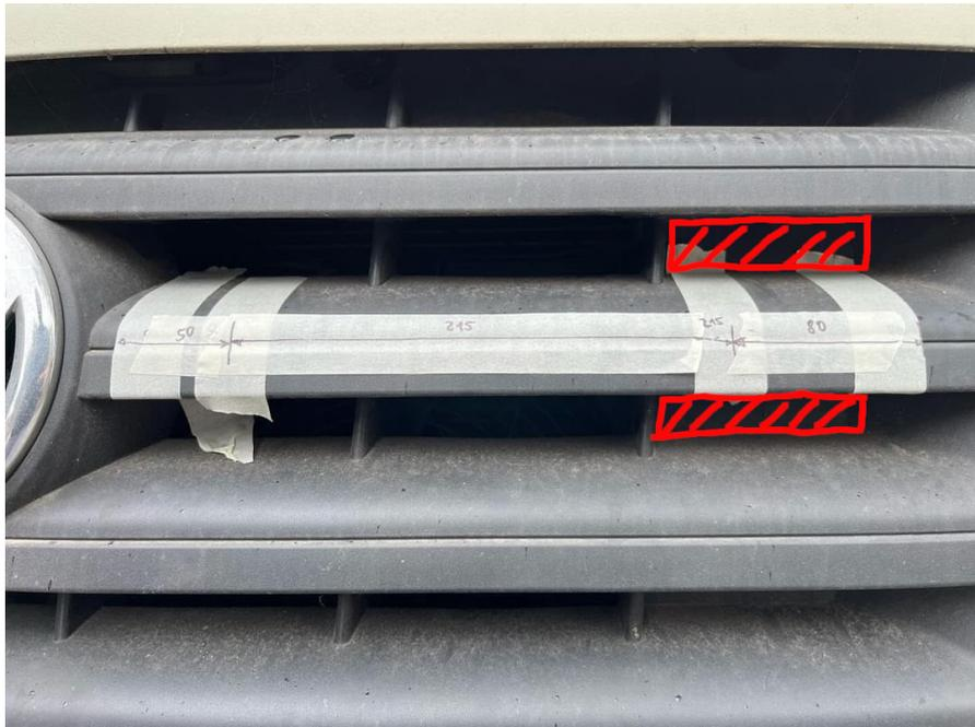
Die Kanten müssen sehr gut entgratet werden damit die Halter ohne Spannung aufgeschoben werden können. Halter müssen nicht verklebt werden.
